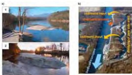
Figure 3.3 : a) Recharge sédimentaire de l'Aar : 12 000 m³ (canton de Soleure, janvier 2005) (1) et 10 000 m³ (canton de Berne, novembre 2005) (2) (Schälichli et al., 2010). b) Recharge sédimentaire de la Mur par injection artificielle et érosion latérale (Kloesch et al., 2008)
