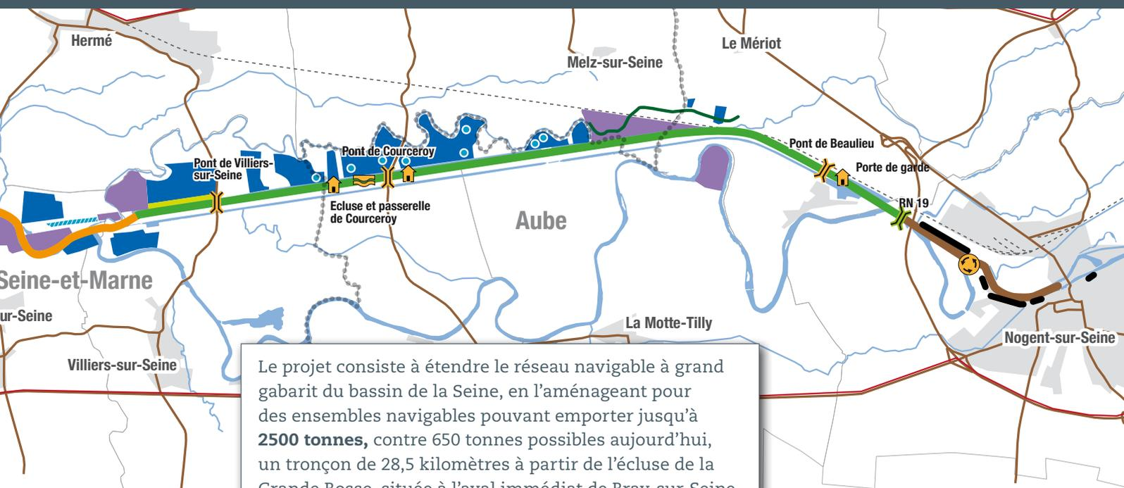
Le projet consiste à étendre le réseau navigable à grand gabarit du bassin de la Seine, en l'aménageant pour des ensembles navigables pouvant emporter jusqu'à **2500 tonnes**, contre 650 tonnes possibles aujourd'hui, un tronçon de 28,5 kilomètres à partir de l'écluse de la Grande Bosse, située à l'aval immédiat de Bray-sur-Seine, jusqu'à Nogent-sur-Seine.
